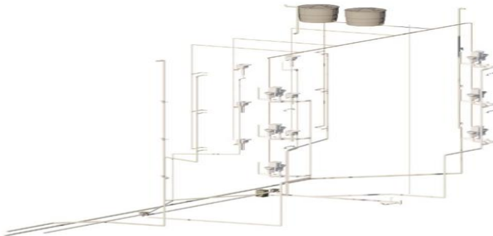
Figura 9 – Modelagem hidrossanitário - Revit 2019
